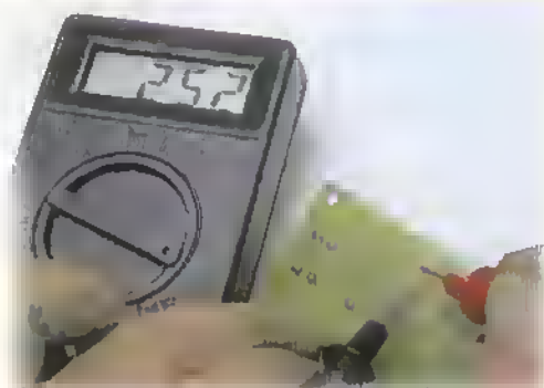
Figura 12.25a. Cortando un circuito impreso para medir corriente
